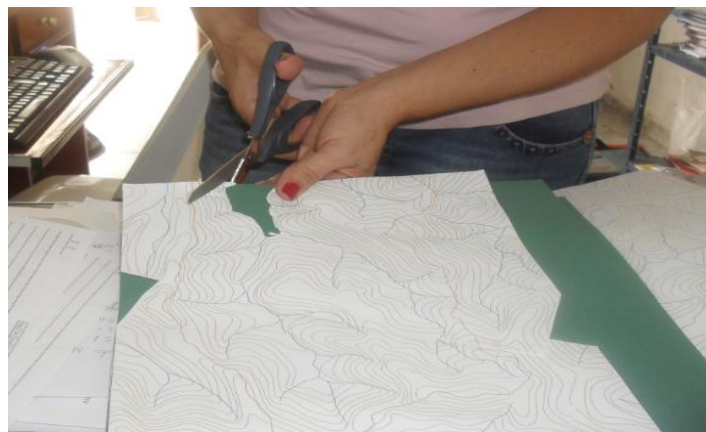
Figura 06. Início do recorte das curvas de nível em EVA, utilizando-se das curvas de nível da carta topográfica.
